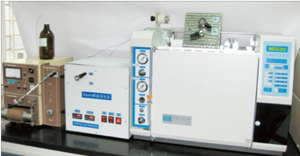
图 9-7 二恶英类污染物样品纯化仪
